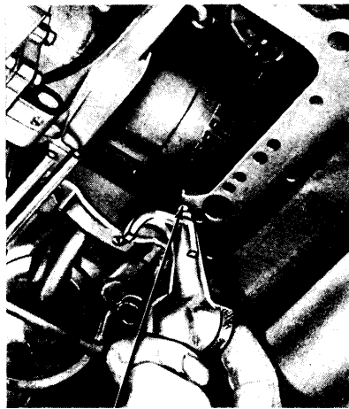
REAR SERVO APPLY PASSAGE D1021-A
